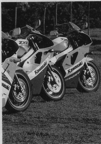
**Les étriers de frein sont identiques sur les trois machines, le diamètre des disques étant de 300 mm sur les deux petites et 310 mm sur la 750. A noter que seule la 400 dispose du dernier raffinement technique en vogue, à savoir la fourche inversée.**
